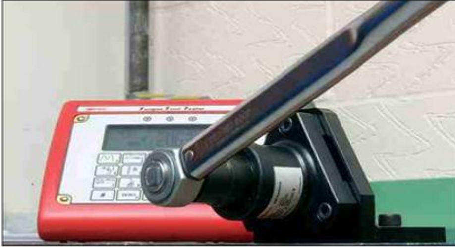
الشكل رقم (٤) : طريقة استعمال مفتاح العزم
