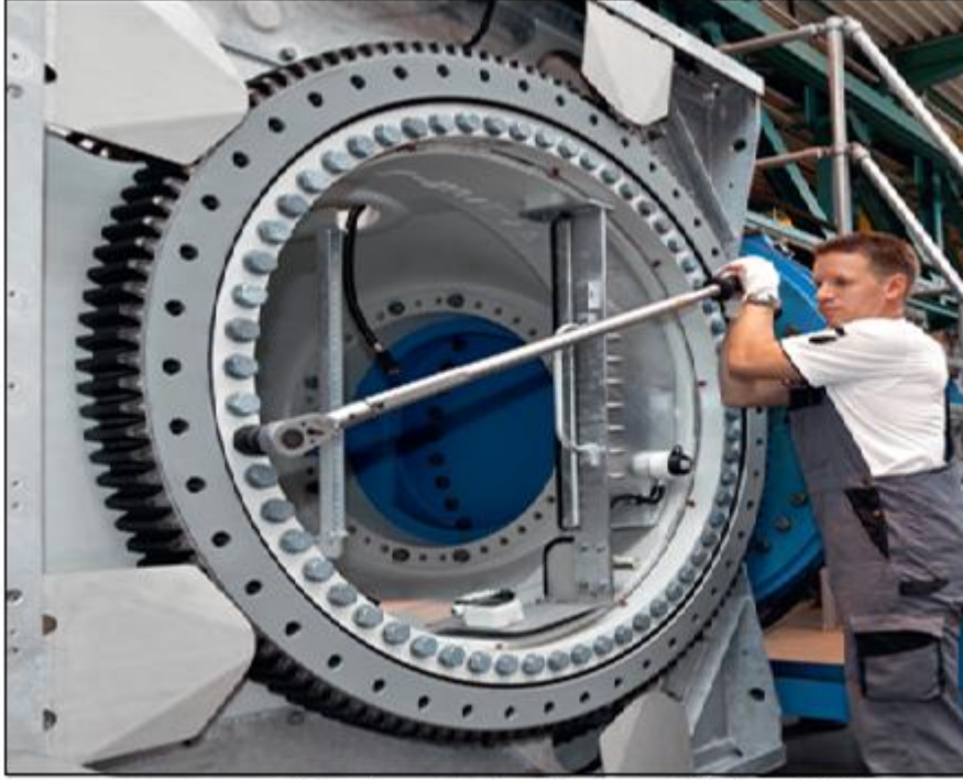
الشكل رقم (١٣ - ب): التثبيت على مسامير التثبيت
